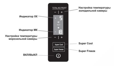
ВКЛ/ВЫКЛ - нажатием данной кнопки можно включить В режиме I CARE отключается вся индикация. весь прибор в целом (как холодильную, так и морозильную камеры). Для отключения холодильника достаточ- Для возврата в обычный режим - выключить и включить но нажать и удерживать в течение 3 секунд кнопку, прибор. холодильник выключится с задержкой 6 секунд.
